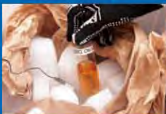
マイナス79度というドライアイスの中に入れてみる。実験を行なった瓶表面の温度がマイナス50度を下回る世界だ。
