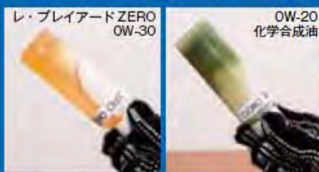
ドライアイスの中に20分ほど入れた状態で瓶を傾ける。柔らかいはずのOW-20はシャベット状だが、レ・プレイアードZEROは問題ない。
